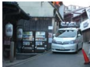
清水寺周辺での車載レーザによる計測
