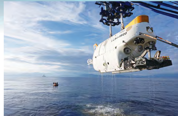
潜航を終え、海上に引き上げられる有人潜水調査船「しんかい6500」。名前のとおり、水深6,500mまで潜航可能(写真提供:海洋研究開発機構)
