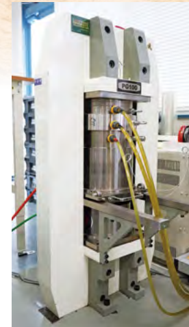
ピストンシリンダー型高温高圧発生装置。最高温度約1,800度、最高圧力3GPaを発生させ、マントルの温度・圧力条件を再現する
