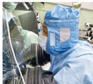
左／実験室(クリーンルーム)内に設置したグローブボックス内で、はやぶさ2探査機が小惑星リュウグウから回収した試料を扱うところ
