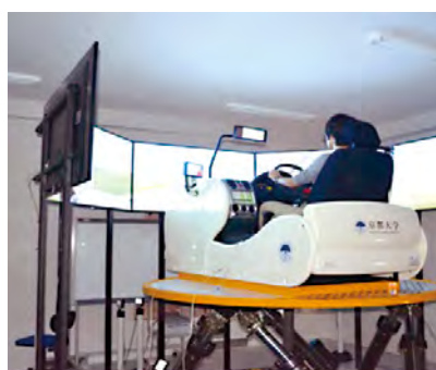
ドライビングシミュレータを用いた実験風景
