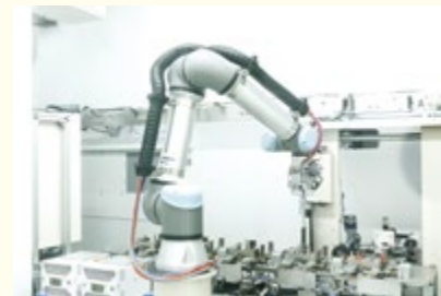
クリニカルバイオリソースの収集ロボットシステム「BRAHMS」。生体試料を高品質な状態のまま採取・処理・保管する。
