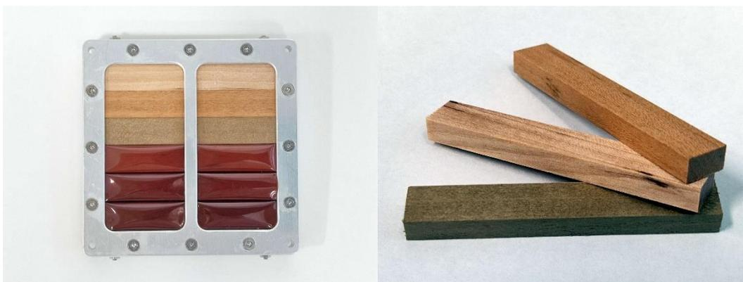
図1 国際宇宙ステーション(ISS)での曝露実験を計画している木材試験体(右)とサンプルパネル(左)：茶色のフィルムは原子状酸素(AO)評価用のポリイミド樹脂シート。
