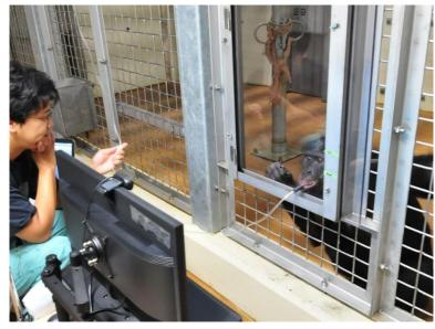
**テスト風景**: モニターで動画を見る際の視線を記録する。モニター下部にアイ・トラッカーが設置されている。アクリル 透明パネル越しにジュースを与え、類人猿の目の位置を固定する。類人猿はジュースを飲みながら、動画を見る。
