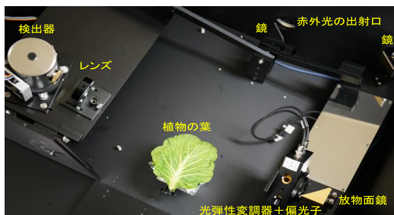
偏光変調赤外反射吸収分光法によるヤセイカンランの葉の測定の様子
