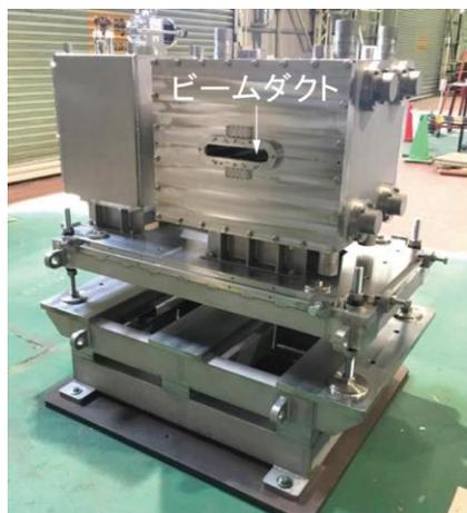
図1 高温超伝導電磁石の外観
