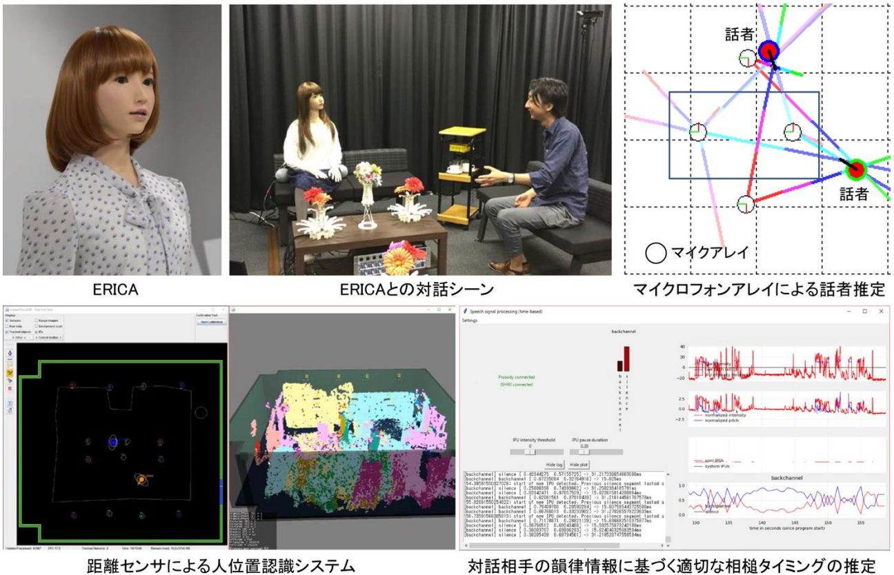
図1 アンドロイド「ERICA（エリカ）」の外観とマルチモーダル対話制御システム
