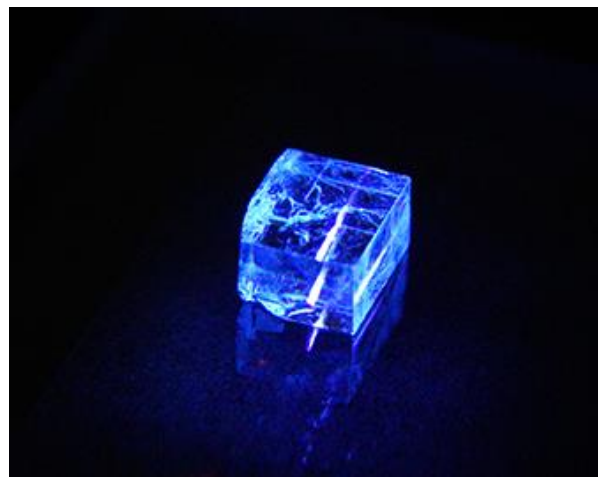
図：メチルアンモニウム塩化鉛( \text{CH}_3\text{NH}_3\text{PbCl}_3 )単結晶の写真（レーザー励起で発光させた場合）。
