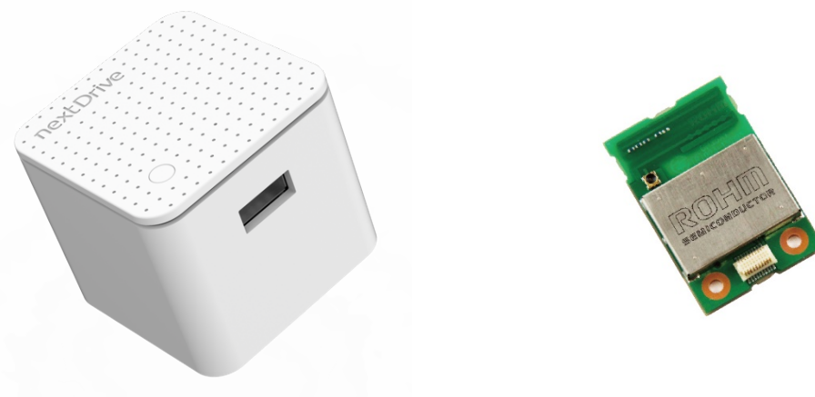
図1:開発した IoT 用ゲートウェイ (左、サイズ 47×47×38 mm) 及び搭載した Wi-SUN FAN モジュール(右)
