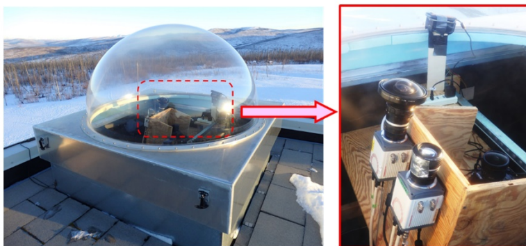
図 2：アラスカ大学のポーカークラット実験場内にあるオーロラ観測施設に設置した高速カメラ。
