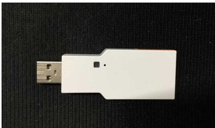
図2 開発した無線機の外観(アクセスポイントとしても使用可能)
