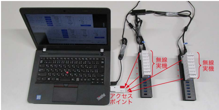
図 4 : 開発した無線実機を用いた複数無線機からの通信実験
