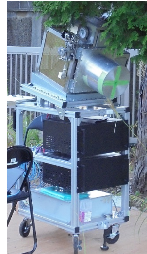
図4：福島の大環境ガンマ線撮影で使用した可搬型ETCC。
