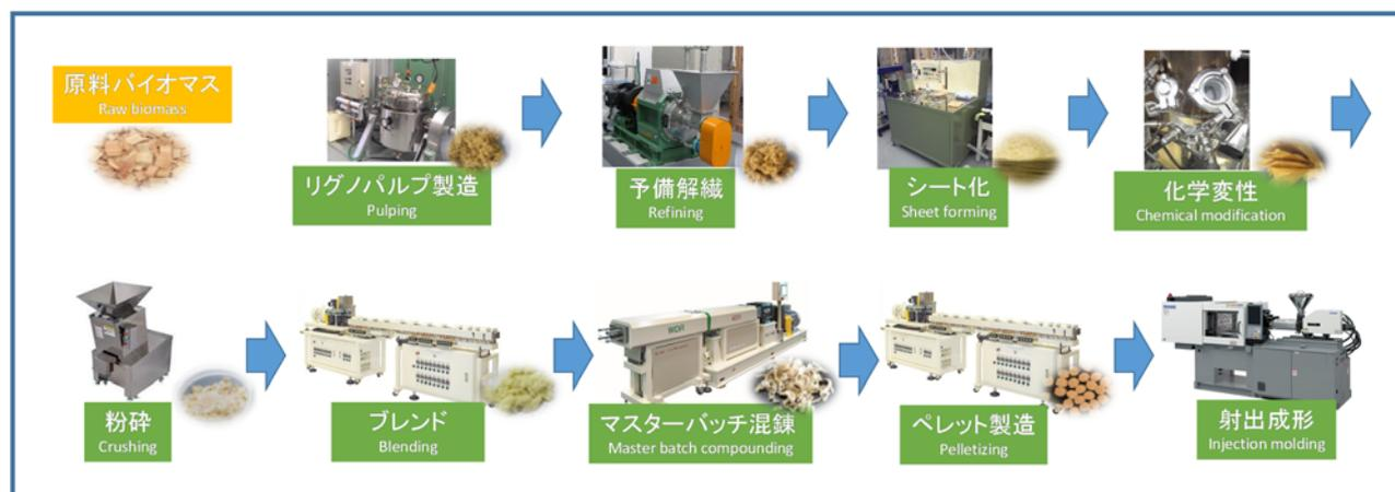
図1 変性リグノセルロースナノファイバー・樹脂複合材料の一貫製造プロセス(京都プロセス)
