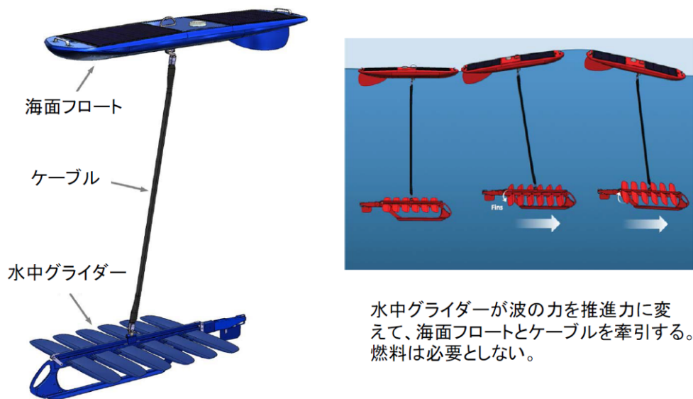
【参考１】ベクトル津波計リアルタイム観測システムの概念図
