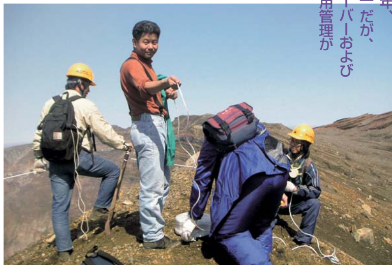
↑馬渡さん（中央）の仕事の一つ、阿蘇の火口湖の縁で湯だまりの採水。お湯はエメラルドグリーンだが、その色はいつも一定のわけではなく時間経過によって変化する。その原因を探るために採水し、主に鉄イオン、二酸化硫黄、硫化水素、浮遊硫黄、フッ化物イオン、塩化物イオンの量を調べる。ロープに採水瓶を取り付け、200メートル先のもう一方の縁との間にロープを渡して火口湖水面まで採水瓶を下ろす。強風も吹き、1リットルの水を汲むだけでも、ロープの張力は何十キロになる重労働だ。
