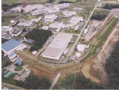
↑写真3 K2K 実験ニュートリノビームラインの全景。ニュートリノビームを生成するための陽子ビームが左下から発射され、神岡方向（右上）に軌道修正された後、ニュートリノビームを発生する。全長約700mあまりある大型の装置である。
