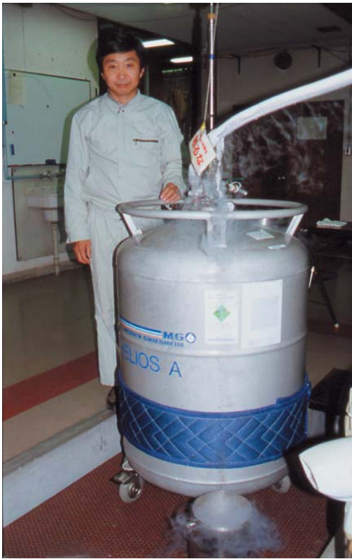
液体ヘリウムは非常に蒸発しやすく、光や振動、小さなエネルギーでも蒸発してしまうほどなので、取り扱いには細心の注意が必要。タンクから各研究室に供給される真空断熱容器（右は断面）は、アルミ箔と樹脂を重ねて輻射熱を遮断するようにしている。
