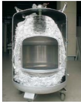
液体ヘリウムは非常に蒸発しやすく、光や振動、小さなエネルギーでも蒸発してしまうほどなので、取り扱いには細心の注意が必要。タンクから各研究室に供給される真空断熱容器（右は断面）は、アルミ箔と樹脂を重ねて輻射熱を遮断するようにしている。
