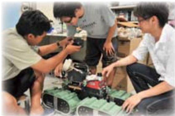
桂キャンパスの実験室における遠隔操作型レスキューロボットKOHGA3のメンテナンス作業の様子
