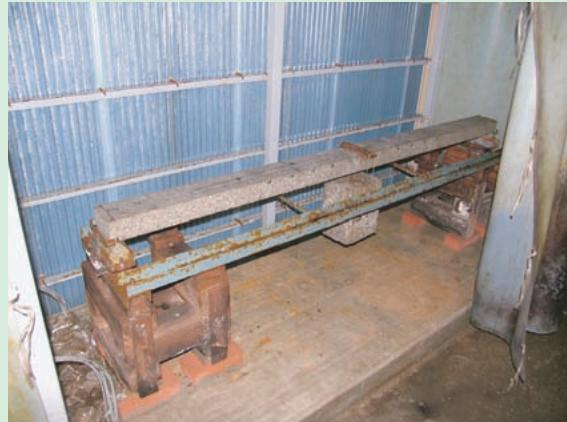
花崗岩流動室内実験のための花崗岩石柱。自重だけでの変形を観るためにもの(上)と、中央部に荷重を掛けているもの(下)がある。
