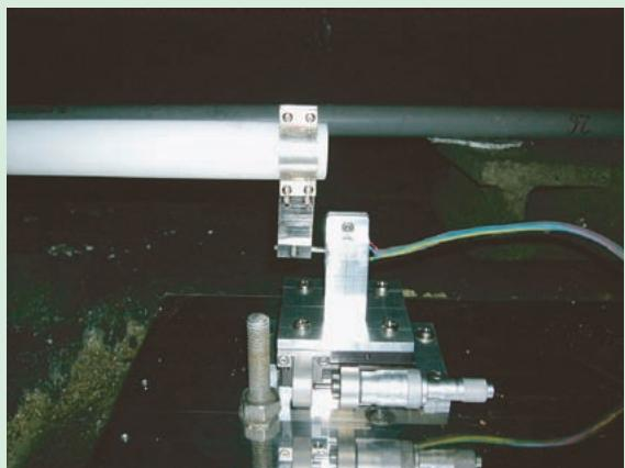
伸縮計の概念図(上)と伸縮計の変位センサー部分(下)。
