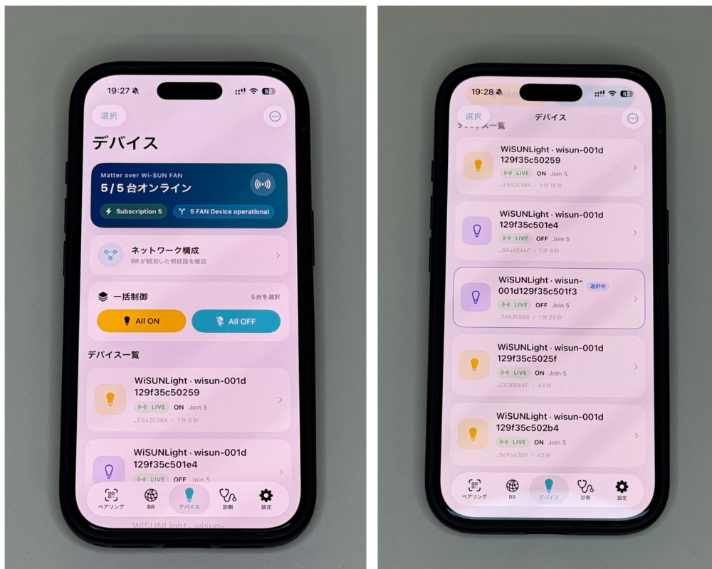
図 3 開発した Matter 対応機器の初期設定・制御用スマートフォンアプリケーションと操作画面
