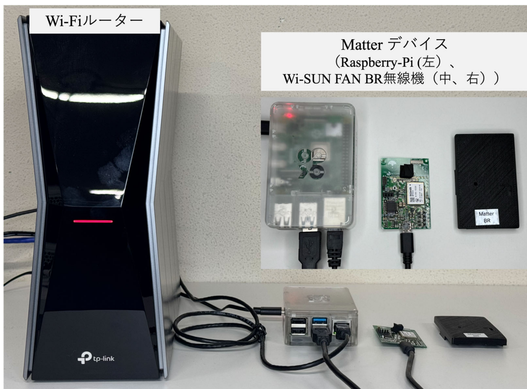
図 1 開発した Wi-SUN FAN ポーダールーター機能を備えた Matter 対応機器
