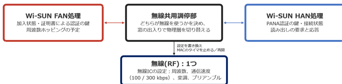
(b) 高速物理層切替え：接続状態を保ったまま、無線の設定だけを書き換える
