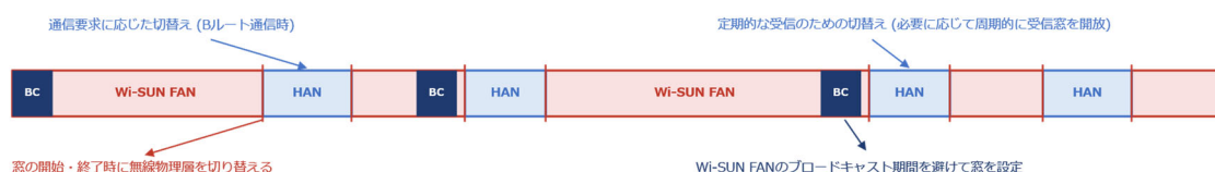
(a) 無線共用調停：一方の通信を主方式とし、他方には所定の期間に限って無線を割り当てる(図はWi-SUN FANを主方式とした場合の例)
