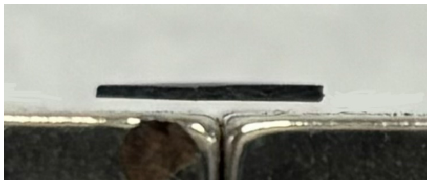
図 2: 永久磁石の上で反磁性浮上する配向表面電気絶縁グラファイト材料
