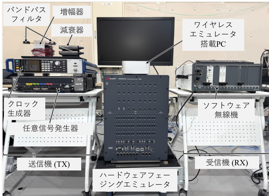
図2 開発したワイヤレスエミュレータと評価システム
