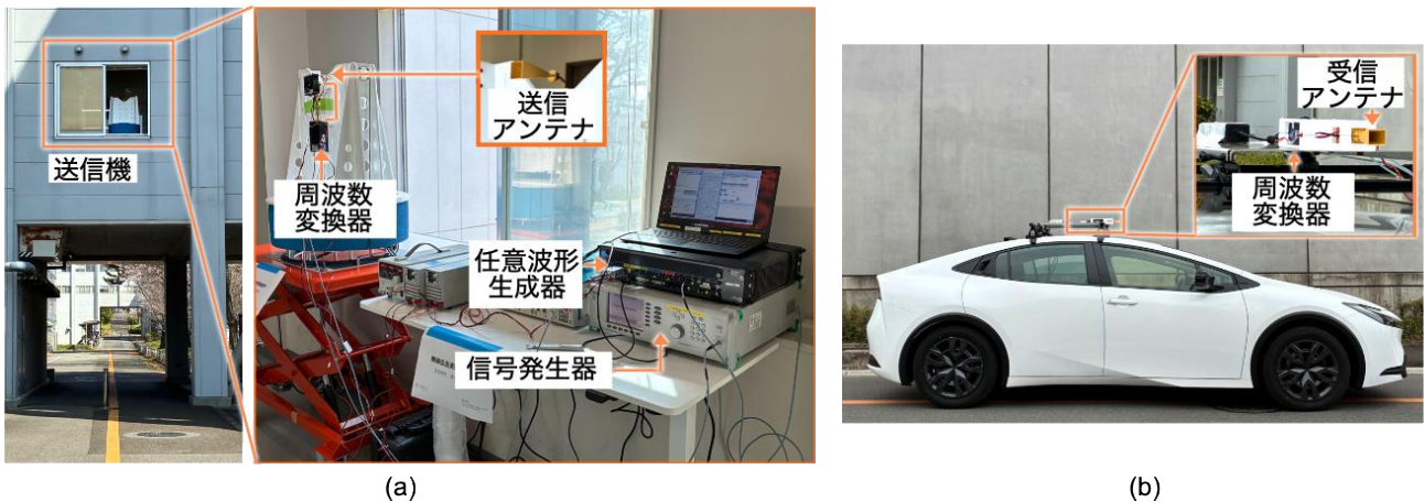
図 1：サブテラヘルツ帯車両向け移動伝送装置（(a) 送信機、(b) 受信機）
