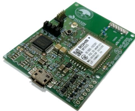
図 2：共通ファームウェアを搭載した無線モジュール
