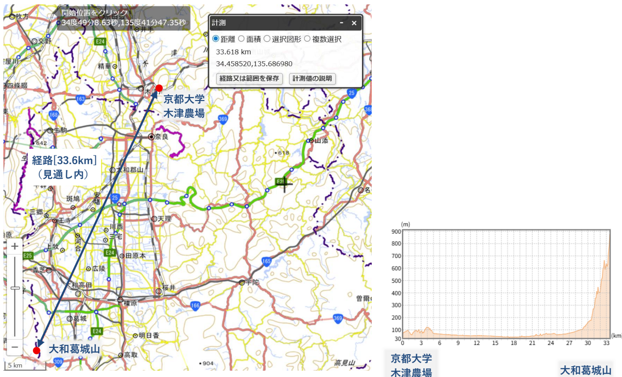
図 1：映像伝送実験の経路と断面図（国土地理院地図を加工して作成）
