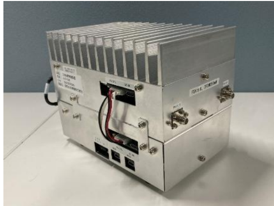
図2：VHF帯（220MHz帯）狭帯域IoT無線システムの無線装置
