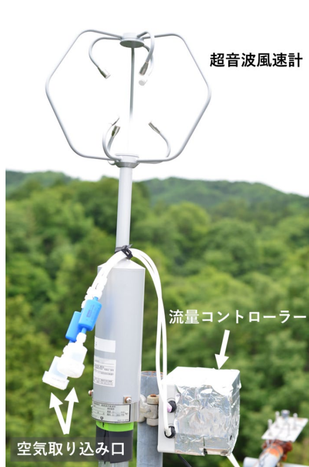
図1 滋賀県南部の森林観測タワー（高さ 29m、桐生水文試験地）に設置された真の渦集積法（TEA 法）に基づく大気サンプリングシステム。超音波風速計が捉える空気の上下の動き（鉛直風速）に応じて、上昇流と下降流を分離・採取する。
