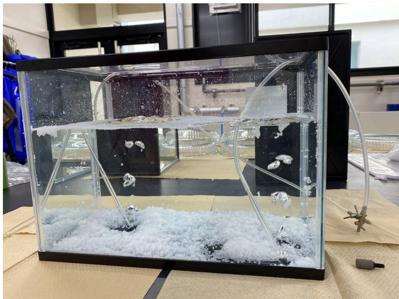
水槽の中でマイクロプラスチック浸出液を作成する
