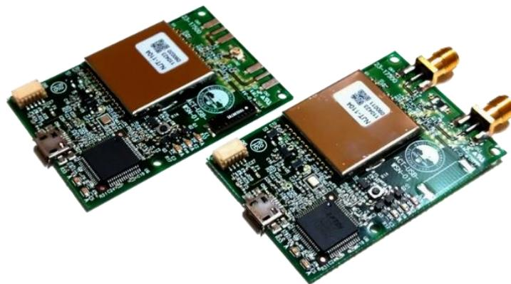
図1：Wi-SUN FAN1.1 向け評価基板(左：形状 A、右：形状 B)
