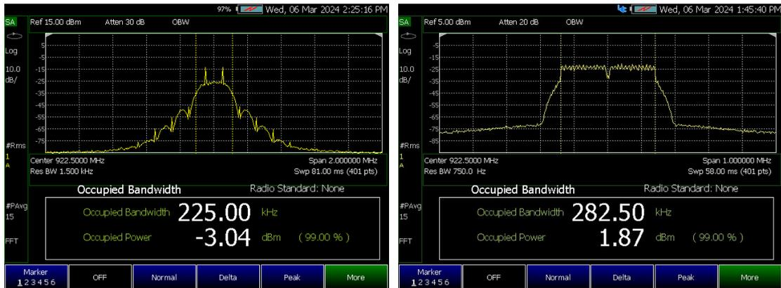
図 2：評価基板の出力波形(左：FSK、右：OFDM)
