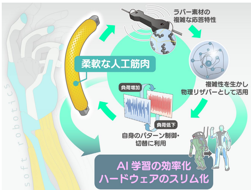
図1(左) 人工筋肉により構成されるソフトロボットアームのイメージ。(右上) 研究の全体像。ソフトロボットの部材である人工筋肉に着目し、ラバーの生成する複雑な応答をニューラルネットワークとして活用することで、人工筋肉自身の動作を制御する。(右下)本研究の成果はロボットの動作学習の効率化やハードウェアの単純化への貢献が期待される。(クレジット:MEDICAL FIG.)
