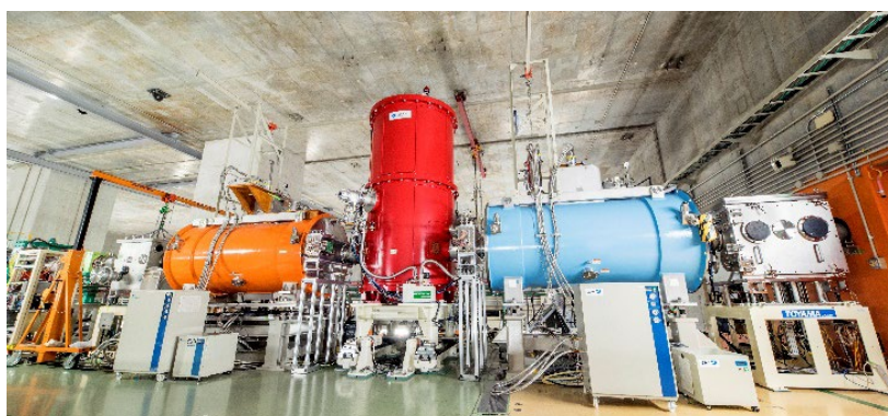
図1：放射性同位体ビーム減速・収束装置 OEDO の全景。
