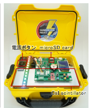
(左) 市民サポーターと進めるシチズンサイエンス「雷雲プロジェクト」のイメージイラスト(製作: fancomi)、(中) 石川県周辺でのコガモの設置場所(黄色い丸点)。(右) 雷雲プロジェクトで製作・設置した「コガモ」検出器(Compact Gamma-ray Monitor, C)の写真。Tsurumi et al., GRL, 2023 から改変。
