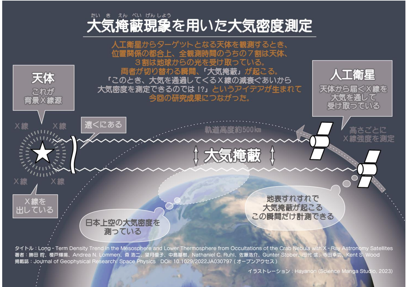
図1: 天体の地球大気掩蔽の様子。人工衛星は反時計回り(東向き)に進み、地球観測から天体観測に移る一瞬(30秒程度)、大気掩蔽で天体のX線強度が減衰し、それにより大気密度が測定できる。
