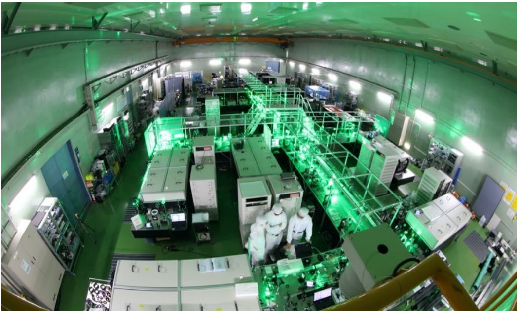
図1. CPA法をベースにして量研関西研で開発されたペタワット級超高強度レーザー装置 J-KAREN。世界トップクラスの強度を誇るレーザーとして、レーザープラズマ加速実験、エックス線発生実験などの高強度場科学研究に利用されています。
