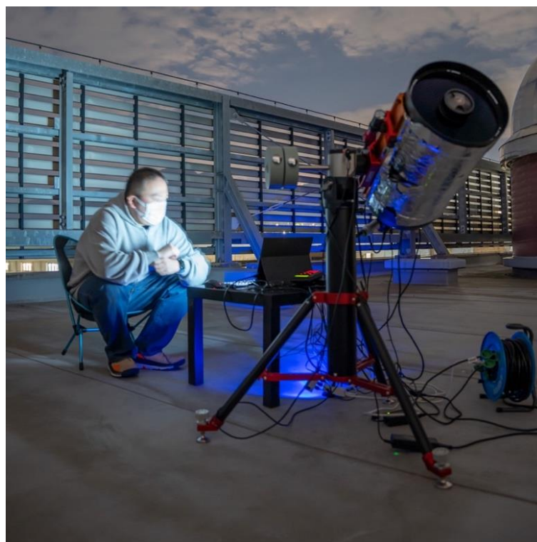
図 2. 京都大学吉田キャンパス某施設屋上に設置された、PONCOTS 観測システム(画像右)を用いて木星のモニタ観測をする様子。
