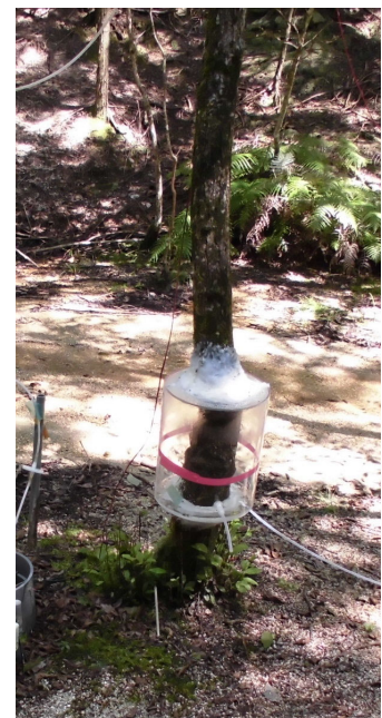
図1 ハンノキの幹からメタンが発生する量を測定するために、チャンバーとよばれる密閉容器を取り付けた様子。
