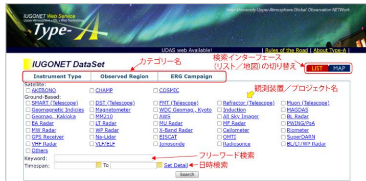
図 1：ウェブサービス「IUGONET Type-A」のトップページ ( http://search.iugonet.org/ )。デフォルトでは、観測装置・プロジェクト名リストからの検索や、フリーワード・日時の入力による検索ができる。また、地図上でデータを検索できるインターフェースも用意されている。
