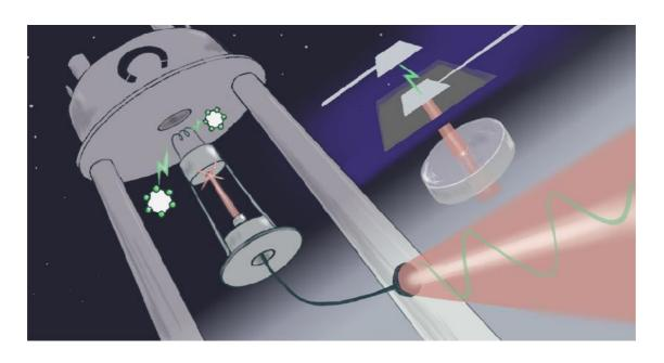
図:小型 EMO NMR 装置のイメージイラスト。超伝導磁石の筒状のスペースに差し込めるような、光検出器を設計・作製し、ベンゼンから発せられる電気的な NMR 信号を光に変換して取得した。装置の内部には薄膜が仕込まれており、NMR 信号を受信すると薄膜が振動して、それがさらに光に変換される仕組みになっている。
