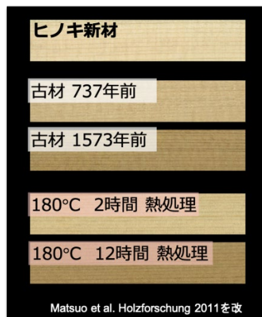
図2 古材と熱処理材は外観がよく似ている。熱処理により経年変化を短時間で再現することを試みている
