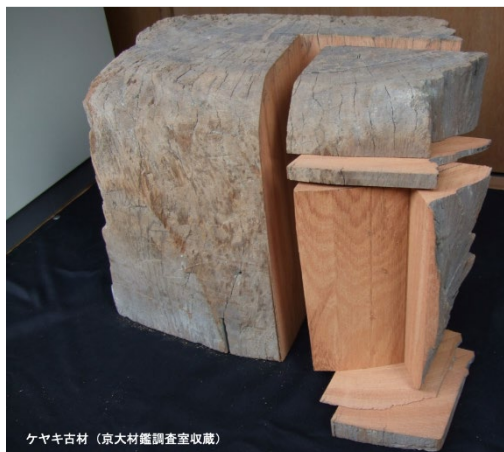
図1 古材の表面は日光や風雨等により劣化しているが、内側には健全部が残る。
