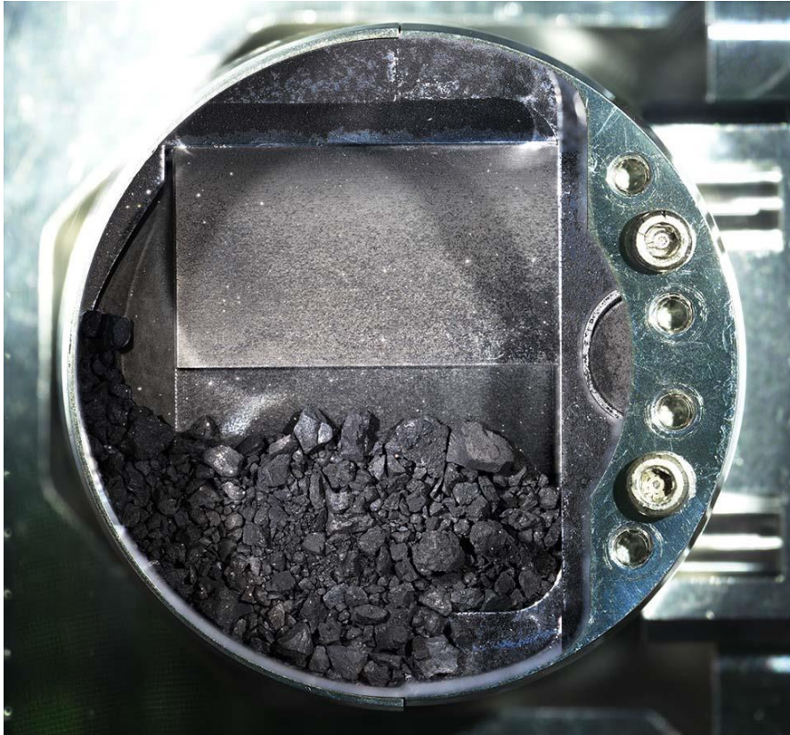
「はやぶさ 2」 サンプルキャッチャ内の粒子 ((c) JAXA)。第一回目のタッチダウン時に採取されたものと考えられる。キャッチャ円筒の直径は 48 mm。
