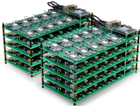
図 4：無線機 100 台収容した試験環境
