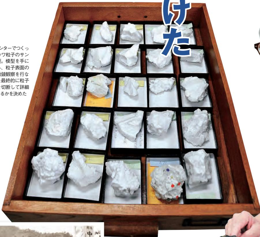
3Dプリンターでつくったイトカワ粒子のサンプル模型。模型を手にしなが、粒子表面の電子顕微鏡観察を行ない、また最終的に粒子のどこを切断して詳細分析をするかを決めた
