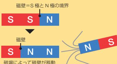
●電流による磁壁の移動
