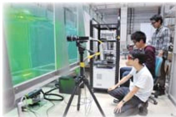
桂キャンパスでの大気海洋シミュレーション高速風洞水槽を用いた台風の成長発達予測モデル構築のための基礎実験
