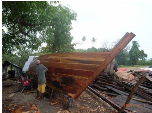
ザンジバルのダウ船製作現場。島に自生しているマングローブの木から作り、4人の作業員で1カ月で完成させる。
