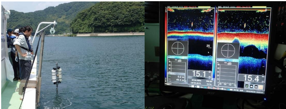
図3. 舞鶴湾での調査の様子。左：環境DNA分析のための採水。右：音響計測。
