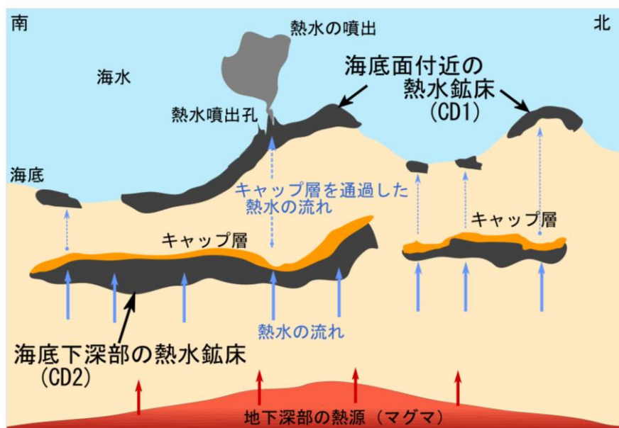
図：本研究で提案された「二階建て」の熱水鉱床の形成メカニズム
