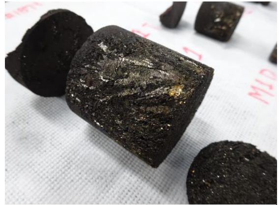
図 5. 海底岩石試料の一例。直径 4cm。金属鉱物を多く含んでいる。
